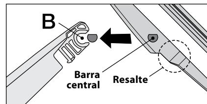
2. Coloque la escobilla de manera que el resalte quede ubicado en la parte inferior de la barra central.
